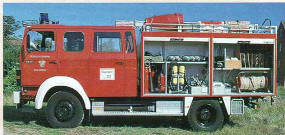
Besonderheiten der Beladung: ein Sprungtuch (soll demnächst durch einen Sprungretter ersetzt werden), Hitzeschutzanzüge, vier sechs Kilogramm CO<sub>2</sub>-Löschers und eine Schornsteinfeger-Ausrüstung für Schornsteinbrände.
