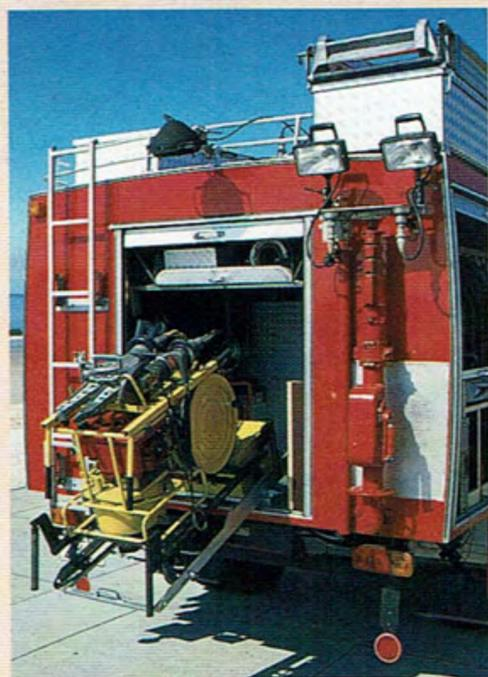
Die GW-Beladung: ein angebauter Lichtmast mit 2 x 70 Watt Halogenscheinwerfern, Dachkästen mit Ölbindemittel, Flaschenzüge, Hebekissen und speziellen Pumpen. Im Heck ist ein tragbares Aggregat für Schere und Spreizer eingeschoben.
