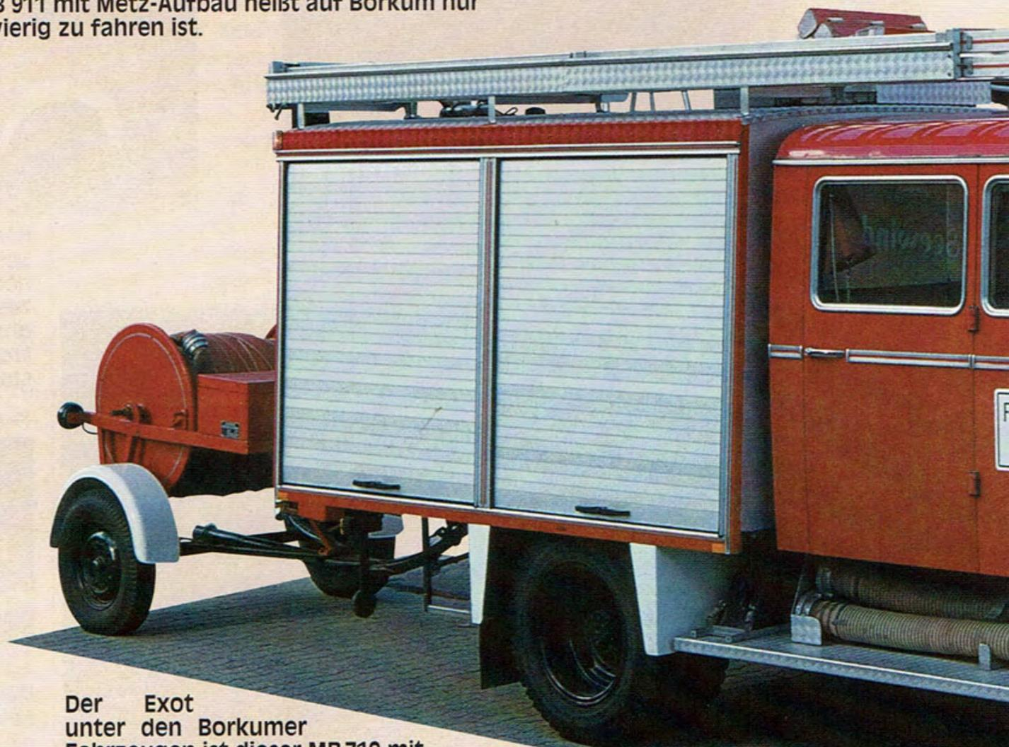
Der Exot unter den Borkumer Fahrzeugen ist dieser MB 710 mit Bachert-Aufbau. 1970 beschaffte die Wehr das Fahrzeug als LF8. Der ursprüngliche Aufbau stammte von Metz. Nachdem die Bleche durchgegammelt waren, ließen die Borkumer 1987 den Aufbau nach eigenen Plänen ersetzen. Jetzt läuft der Mercedes als LF8 mit Zusatzbeladung Schlauch (SW1000). Den Schlauchanhänger bauten die Feuerwehrleute auch selbst.
