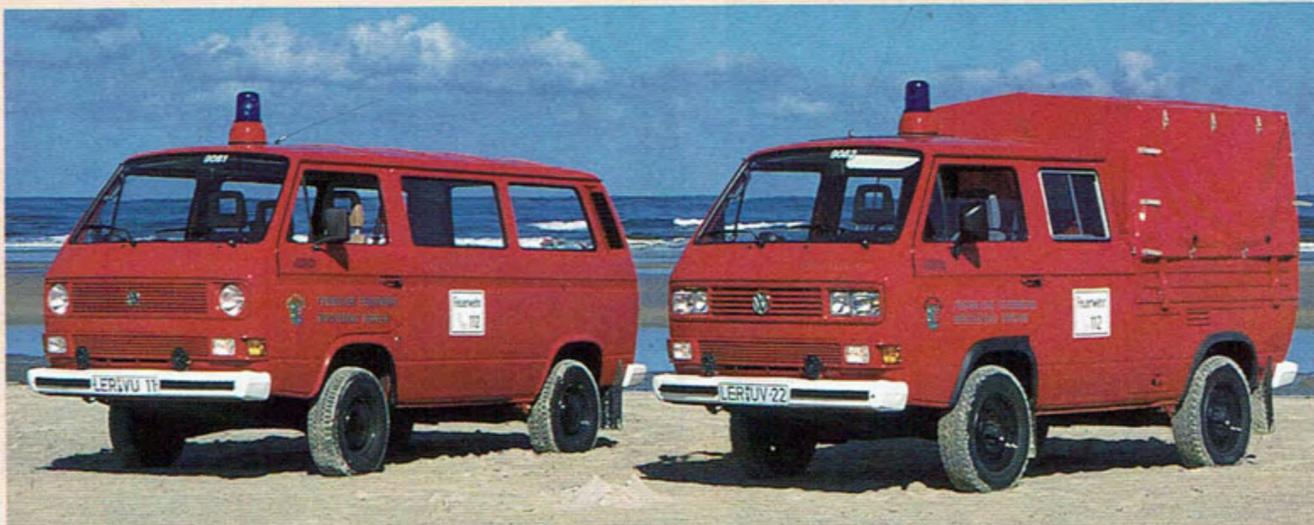
Die MTW 1 und 2 (Pritsche), beide VW T3, sind mit Allradantrieb für Fahrten am Strand ausgestattet. Der MTW 1 wird auch als ELW genutzt.
