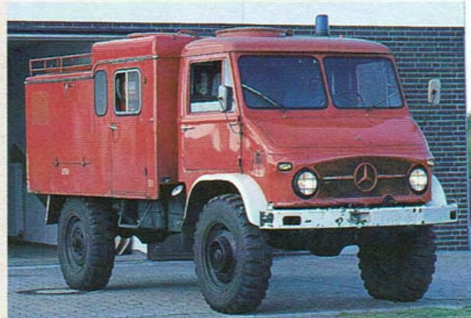
Auf dem Inselflugplatz steht dieser Unimog S404 mit 250 Kilogramm Pulver und 100 Litern Lightwater für den Ersteinsatz bei einem Flugzeugunglück.
