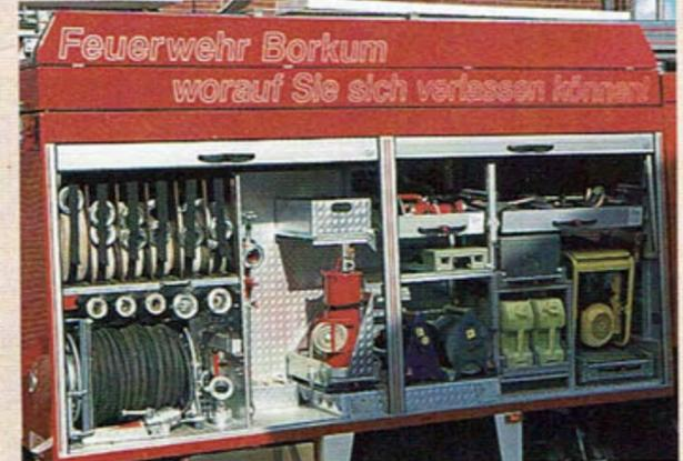
Auf der rechten Fahrzeugseite befindet sich ein 50 Meter Schnellangriff (S28), ein Boschaggregat, Schläuche, Kabel und Kraftstoffkanister. Oben am Fahrzeug der Slogan der Feuerwehr.
